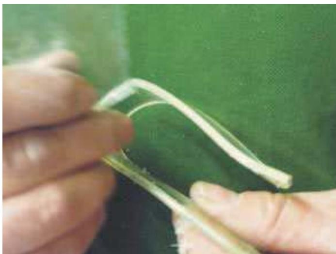
El tenedor se centra a 2cm del extremo inferior del molde y a 1cm y 4cm del extremo inferior del tenedor se le hacen 2 orificios al tenedor con la broca de 3cm.
